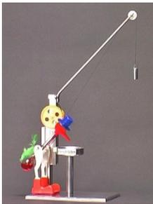
Der Einsatz der Ente in der Hebevorrichtung belegt, dass es sich tatsächlich um eine Stoffkraftmaschine handelt. So kann mit ihrer Hilfe die beim Übergang vom höheren Potenzial  $\mu_1$  des flüssigen Wassers im Becherglas zum niedrigeren Potenzial  $\mu_2$  des in der Umgebungsluft verdünnten Wasserdampfes gelieferte Energie ( $W < 0$ ) genutzt werden:
