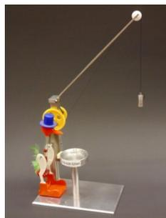
Si se le coloca al pájaro un dispositivo adecuado, su movimiento se puede utilizar para levantar un peso pequeño.
