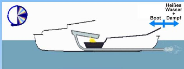
Kocht das Wasser, so wird ein Dampfstoß erzeugt; dadurch wird das Wasser in den Rohren nach hinten ausgestoßen und das Boot bewegt sich vorwärts.
