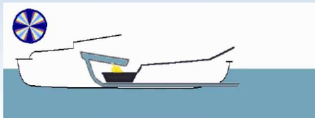
Durch den Unterdruck wird Wasser in die Rohre und den Verdampfer eingesaugt. Der Kreislauf kann erneut beginnen.
